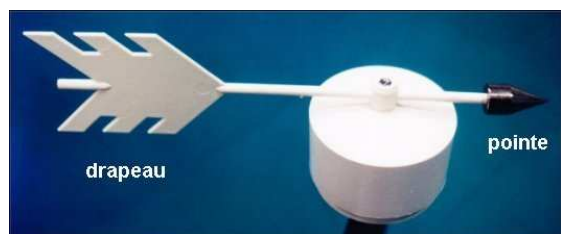
Ce capteur est une tête de girouette à transmetteur.
